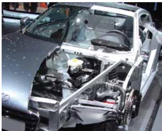
Chassis de l'Audi R8 composé à 100% en Aluminium. (Profils extrudés, tôles et pièces moulées).
