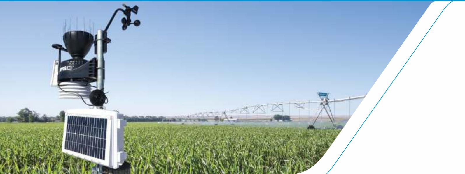
A Weather Station é a estação meteorológica da Valley que faz monitoramento climático e auxilia na tomada de decisão de irrigação, pois calcula a ETO – Evapotranspiração de referência.
