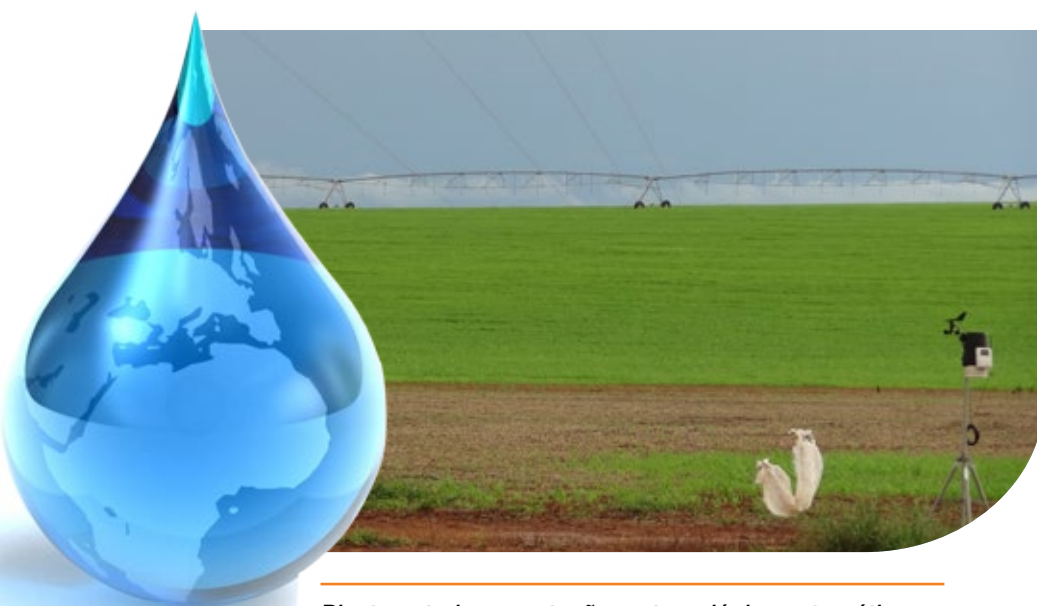
Pivot central com estação meteorológica automática ao lado para estimativa da demanda hídrica diária.
