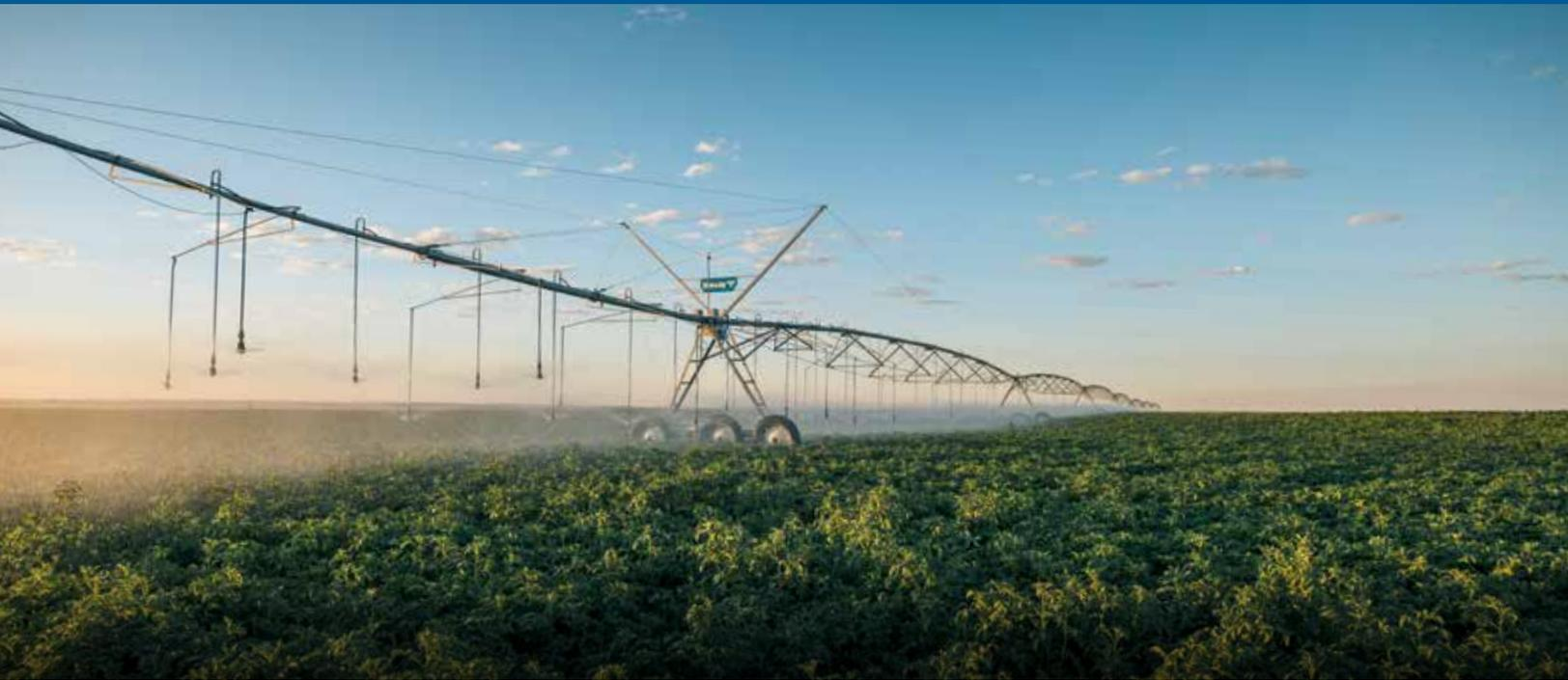
新型 Valley X-Tec® 驱动装置提供极致组合：顶尖的速度性能可加快灌溉周期，而动态功率可应对最崎岖的地形。凭借专利对准技术和稳健的直流电机，喷灌机能以平稳且一致的步速移动，即便是在多变的地形上也不受影响。
