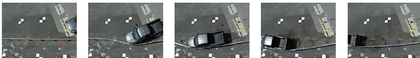
Impacto Re-directivo en defensa EZYGUARD 4 con vehículo de 2270kg a 100kph/25° (Ensayo 3-11 MASH)
