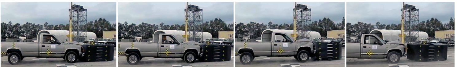
Impacto frontal de camioneta pick-up de 2000kg con un poste protegido por Raptor™ a 50 kph
